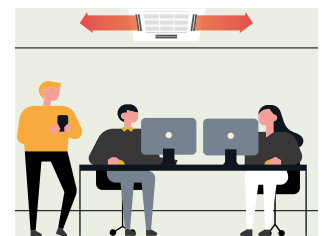
Indirekt luftflöde vid detektering av rörelse.
